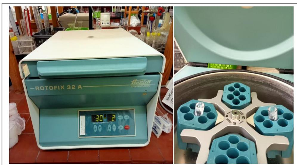
**Figure IV.47 : Essai de stabilité par la centrifugation (Hassnaoui M 2022).**
