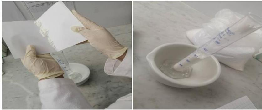
**Figure 4 et 5** : remplissage de la poudre dans l'éprouvette.
