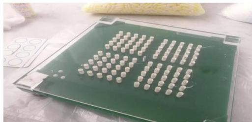
**Figure 8** : corps de gélules placés dans le gélulier.
