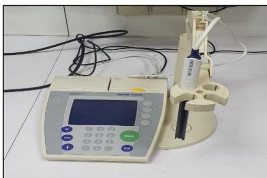
**Figure 13:** pH mètre METTLER TOLEDO SevenMulti
