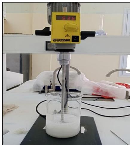
**Figure 8 :** Agitateur à helices YELLOW LINE OST 20 DIGITAL
