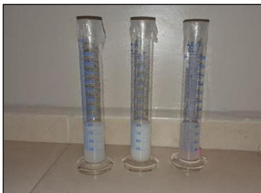
**Figure 16 :** Test de sédimentation et de remise en suspension
