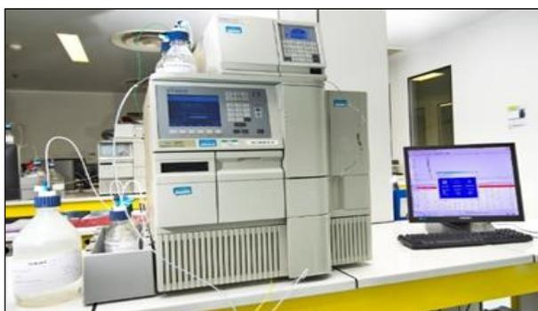
**Figure 17:** Appareil HPLC WATERS associé à un logiciel EMPOXER 3 SOFTWARE.
