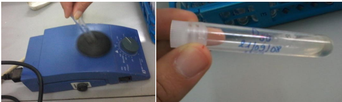
Figure 35: Homogénéisation du plasma au moyen de l'agitateur de type vortex ( photo originale ).
