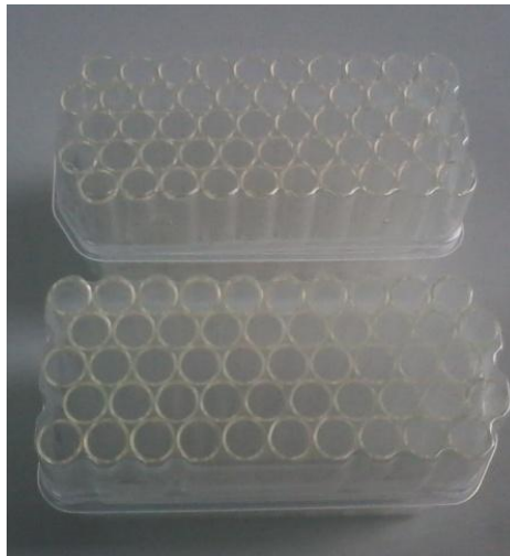
Figure 32: Tubes en plastique recouverts d'anticorps anti-androsténedione (photo originale).
