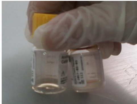
Figure 31: Flacons de calibreurs avant (à droite) et après (à gauche) reconstitution (photo originale).
