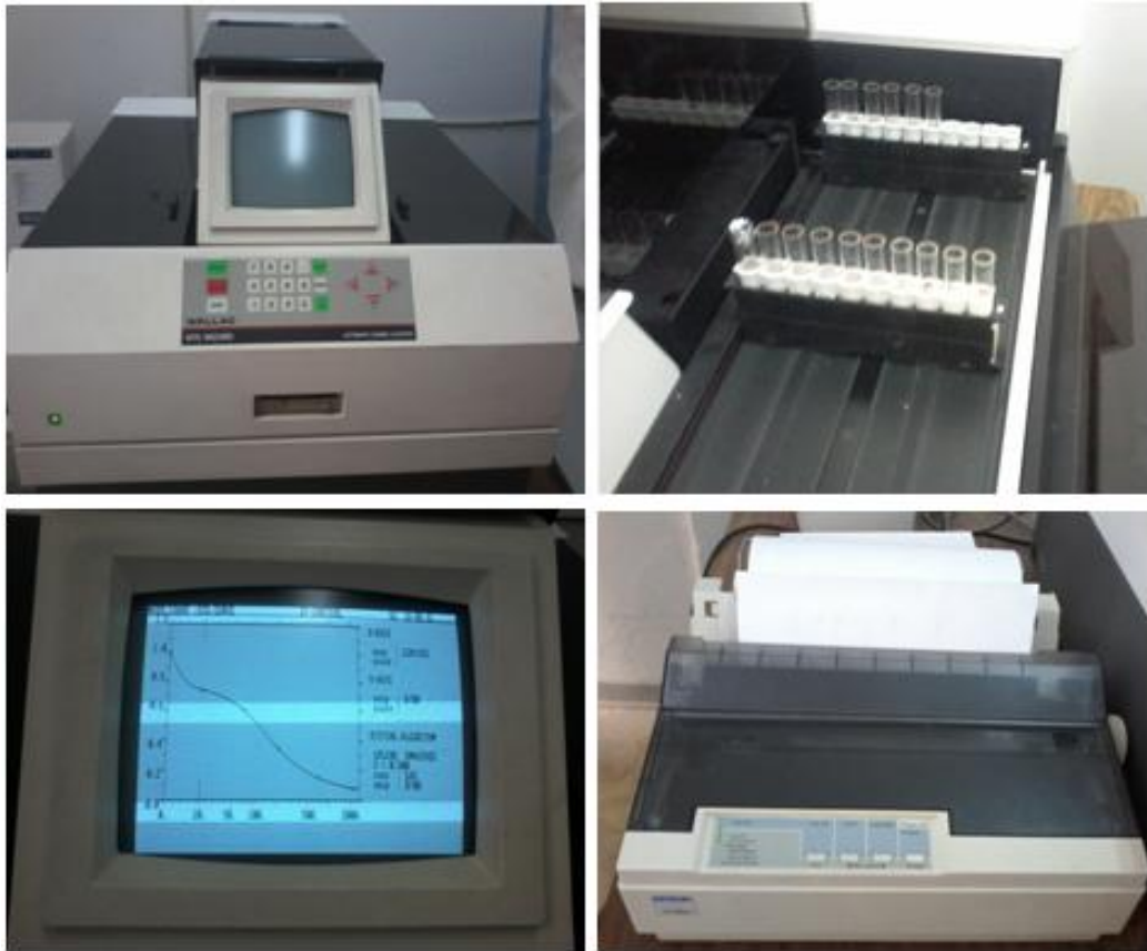
Figure 40 : Compteur gamma calibré pour l'iode 125 (photo originale).
