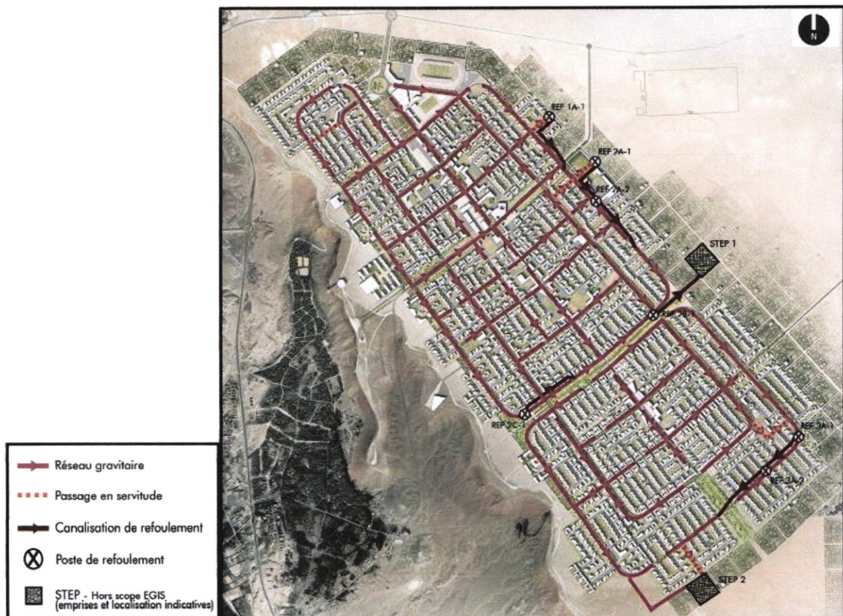
Figure 53 : Réseau des eaux usées ; source : Egis 2012.
