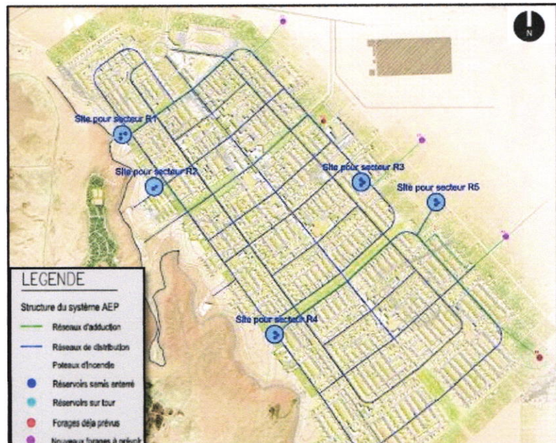
Figure 52 : Réseau d'alimentation en eau potable ; source : Egis 2012.
