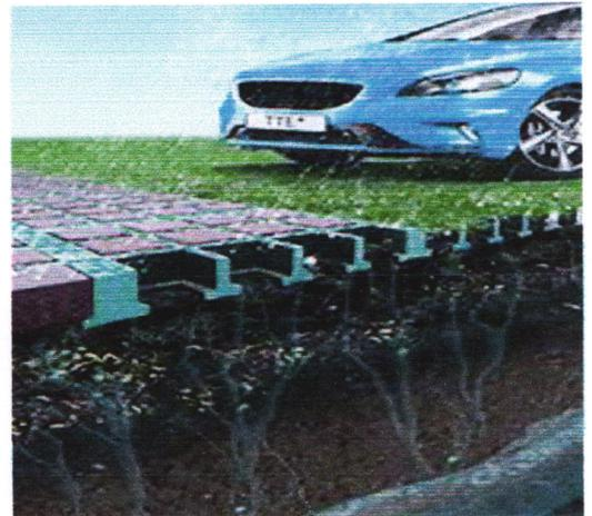
Figure 117 : systèmes de dalle perméable pour la collectes et récupération des eaux pluviales
