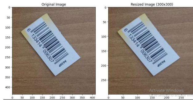
Figure 2.3 : Redimensionnement d'une image à l'aide d'OpenCV
