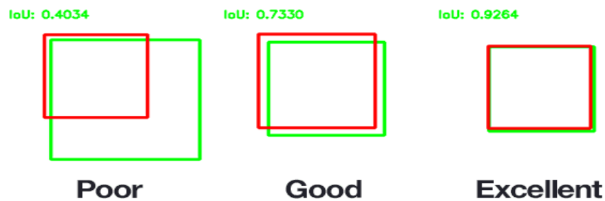
Figure 2.41 : Exemple de calcul de l'intersection sur les unions pour différentes boîtes englobantes
