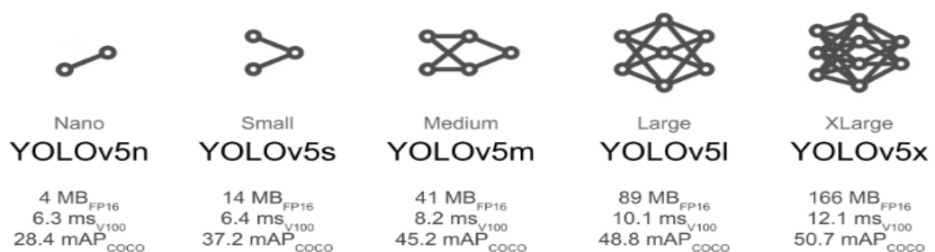
Figure 2.28 : Comparaison des modèles YOLOv5
