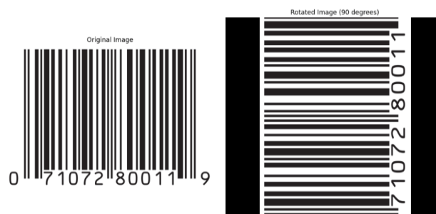
Figure 2.2 : Rotation des images à l'aide d'OpenCV
