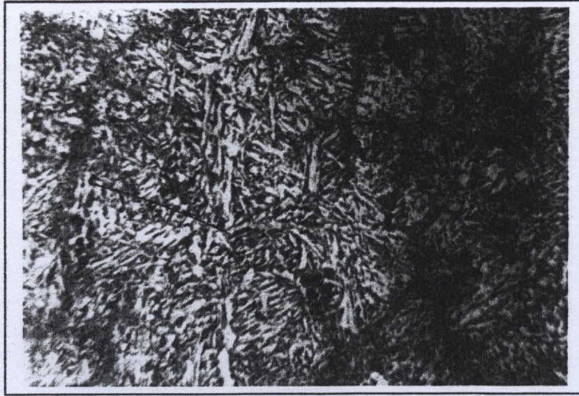
FIG N° 28 : Micrographie optique (X500) de la nuance à 0.0085%Ti à l'état brut de coulée ( Structure Widmanstätten)
