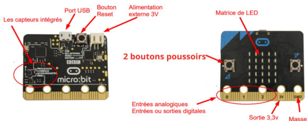
Figure III. 12: Les composants de la carte micro:bit [27]
