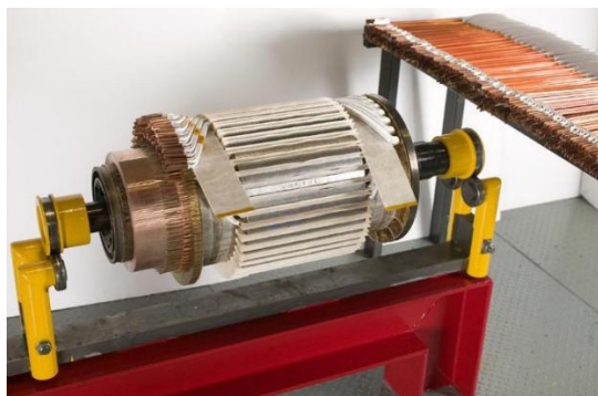
Figure III. 4 : Induit d'une machine à courant continu.[20]
