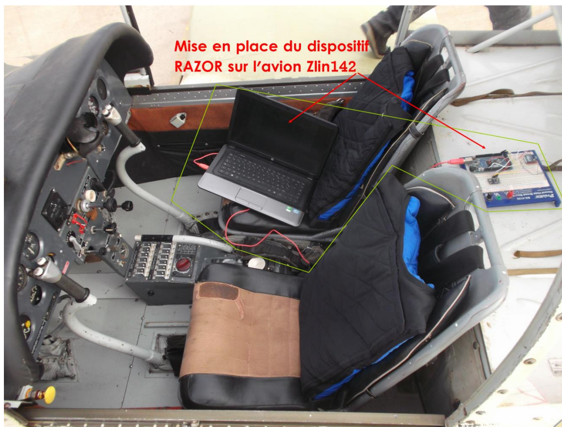
Figure (41) : Installation de la plate-forme de travail dans le cockpit de l'avion Zlin142
