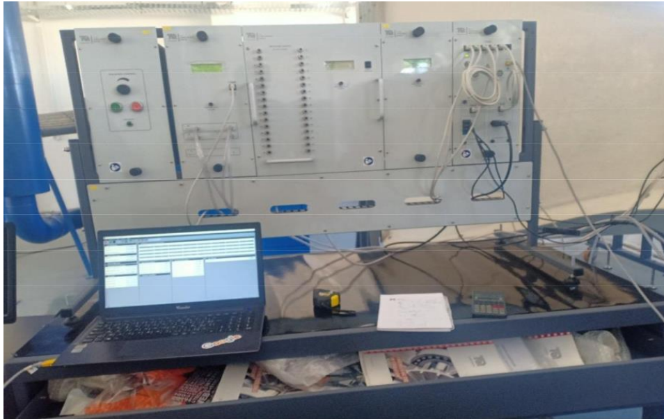
Figure IV.25: le montage de Pc avec la soufflerie.
