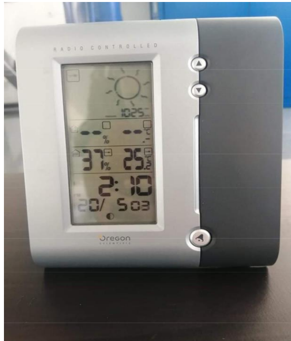
Figure IV.27: la station mobile de mesure météorologique.
