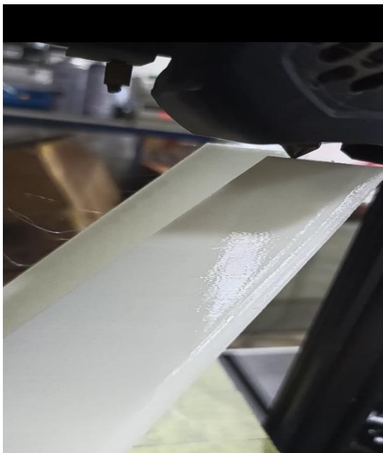
Figure IV.10: Impression du fuselage et les ailes
