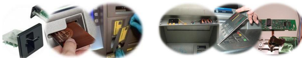
Figure 17- Le dispositif du skimmer (mini-caméra et faux lecteur). [31]
