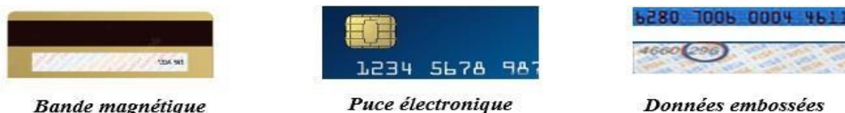
Figure 15- Les cibles d'attaques (Bande magnétique, puce électronique, données embossées)
