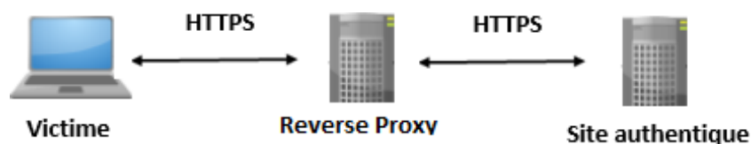
Figure 33- Schéma du reverse proxy
