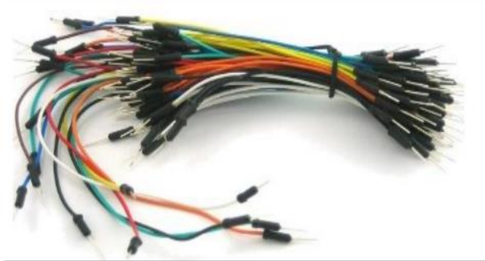
Figure 27: les files de câblage « jumpers ».
