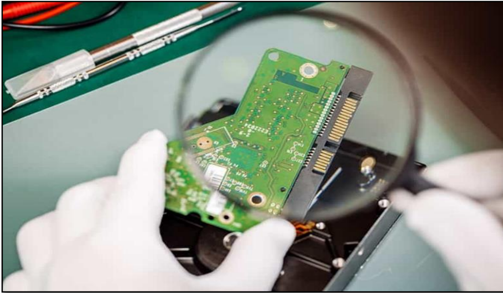
Figure 14: inspection visuelle afin de vérifier les joints de soudure.
