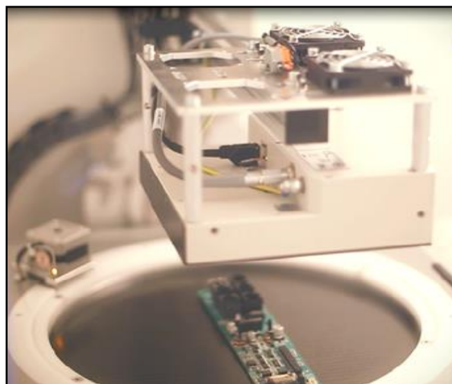
Figure 15 : inspection au rayon X.
