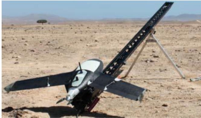
**Figure 6: système de lancement de drone**
