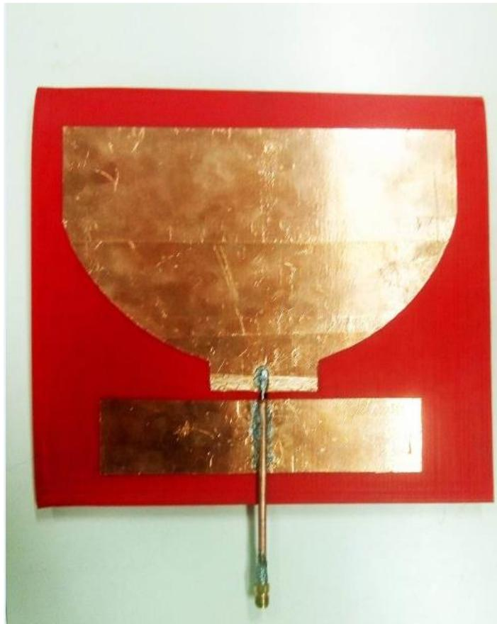
**Figure III.10 : Antenne réalisée**
