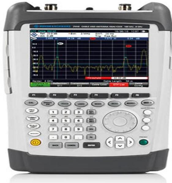
**Figure III.12 : Analyseur de réseaux vectoriels portatifs de la série ZVH [22]**
