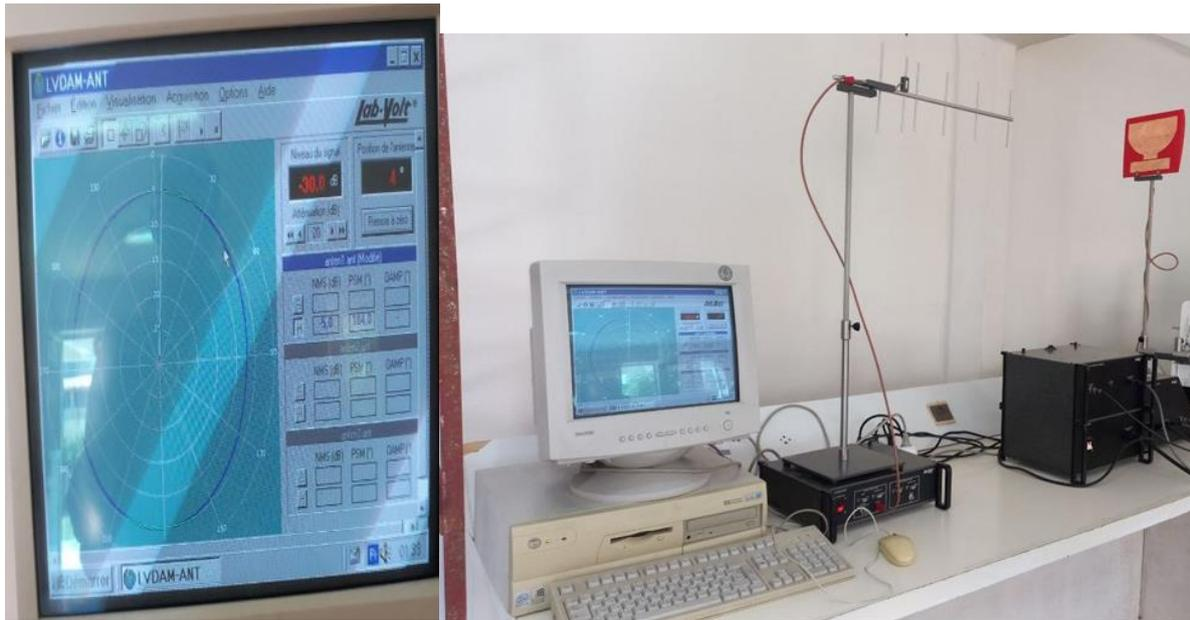
**Figure III.18 : Antenne installée sur le banc de teste et son Diagramme de rayonnement mesuré**
