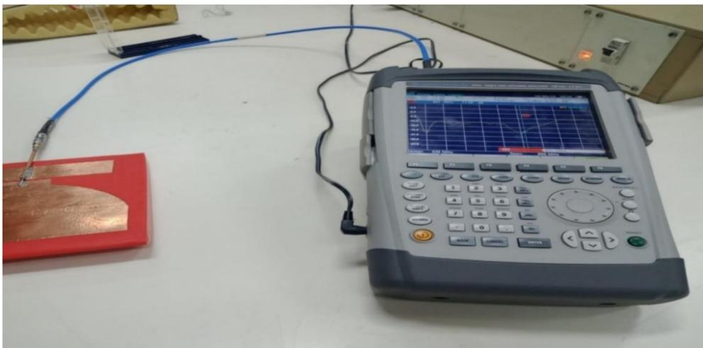
**Figure III.13 : Antenne proposée lors de la mesure du son coefficient de réflexion**
