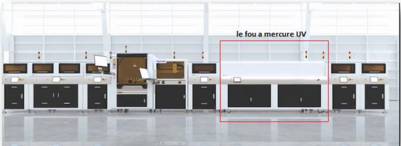
Figure 6 unité de fabrication des barrettes de LED
