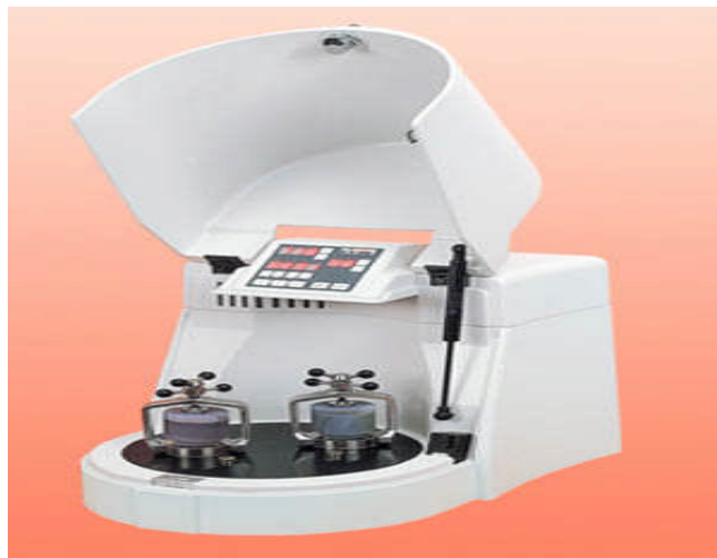
Figure 3.2 : Broyeur planétaire « compact de table « MiniMill » »
