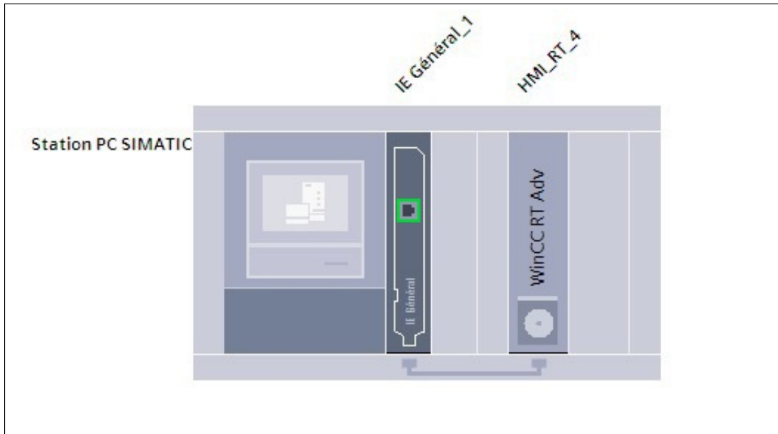
FIGURE IV.16 – Carte reseau du poste de supervision
