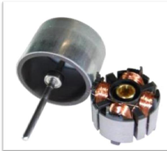
Figure 1.6 Rotor et stator d'un moteur sans balais à rotor externe
