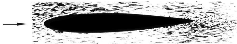
Figure 1.18. Visualisation d'un écoulement autour d'une aile symétrique à incidence nulle dans un canal hydrodynamique. [38]
