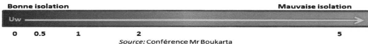
Figure13:Performance de vitrage calculée avec le coefficient UW
