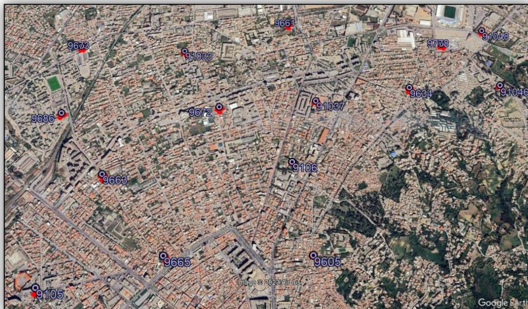
*Figure III.7: Positionnement des sites et émetteurs 4G LTE via Google Earth.*
