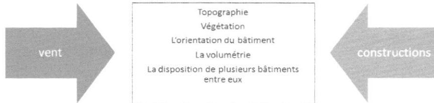
Figure 15 Les facteurs qui déterminent les effets du vent ; Source : Adapté par l'auteur à partir de R.GONZALO ; K.J.HABERMMAN ;Architecture et efficacité énergétique :Principes de conception et de construction; édition BIRKHAUSER
