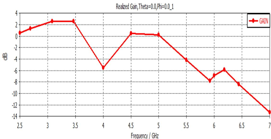
**Figure 3. 3.** Variation du gain de l'antenne bi-bande en fonction de la fréquence.
