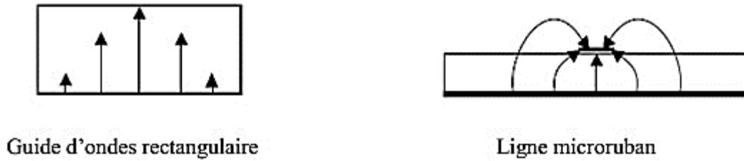
**Figure I.15:** Lignes de champs dans un guide d'onde rectangulaire et dans une ligne micro-ruban [25].
