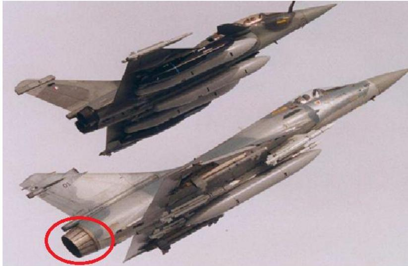
**Figure I.4 :** Tuyère d'un avion de Combat.
