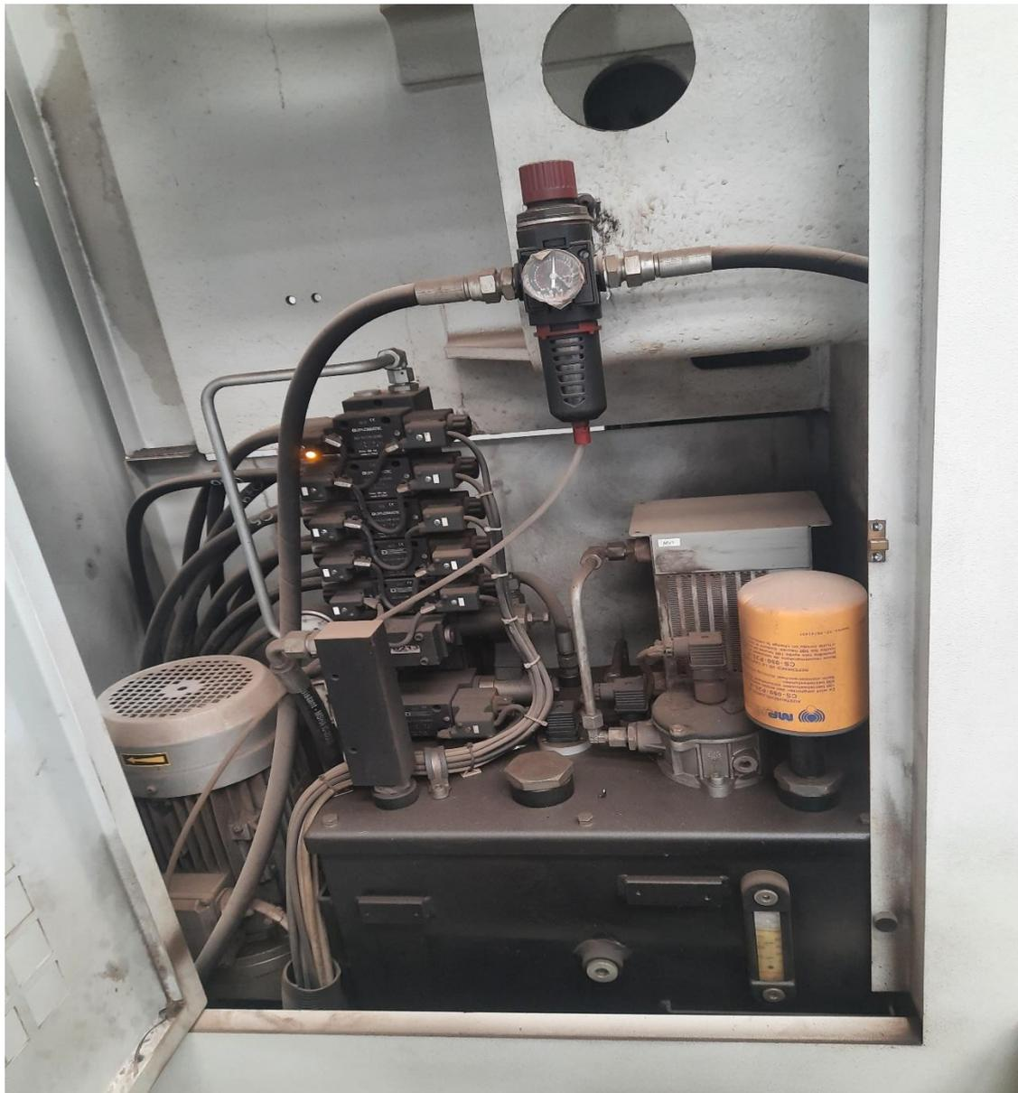
*Figure 3- 18 Image réelle de Groupe Hydraulique*
