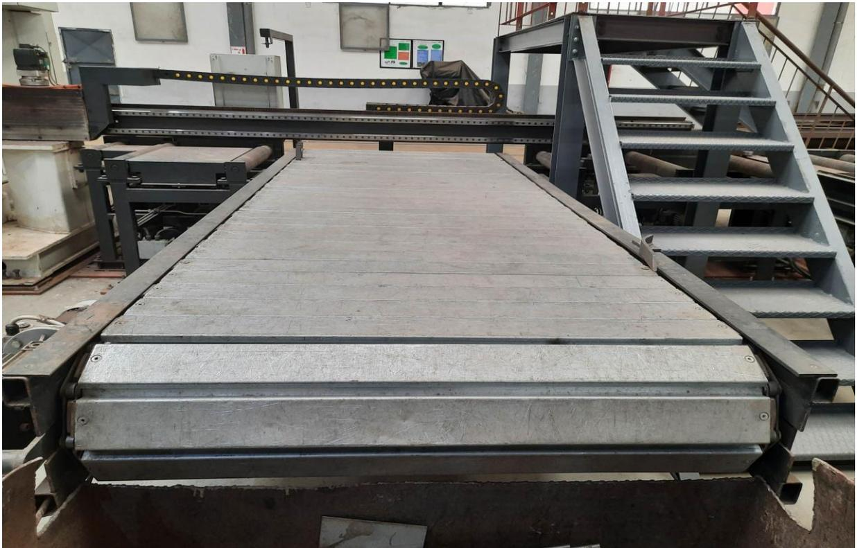
Figure 2- 14 Rouleaux de déchargement
