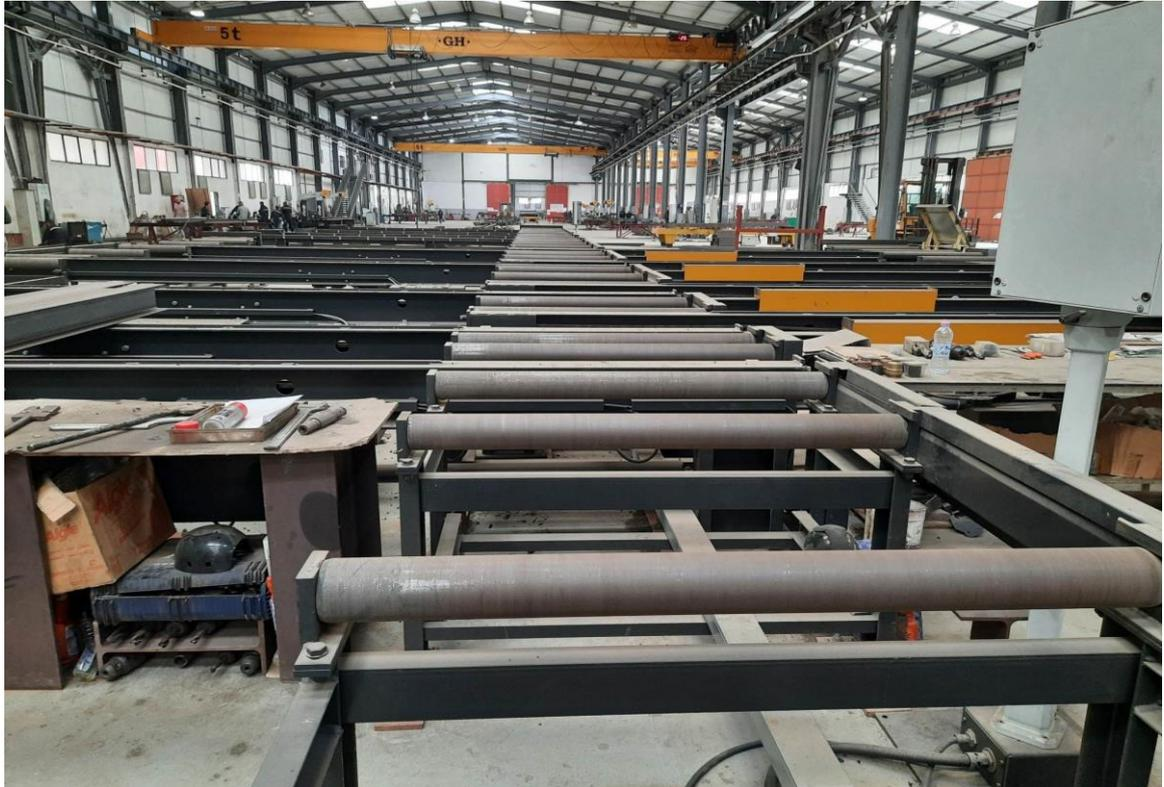
Figure 2- 15 Banc de déchargement
