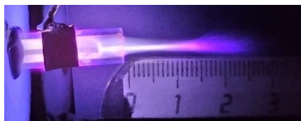
Figure I.8 (b) : L'allumage de la décharge plasma.
