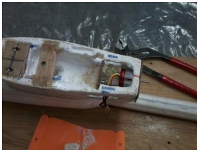
Fig. 6-27 : La fixation de l'aile, le moteur, la poutre de queue et les équipements électroniques
