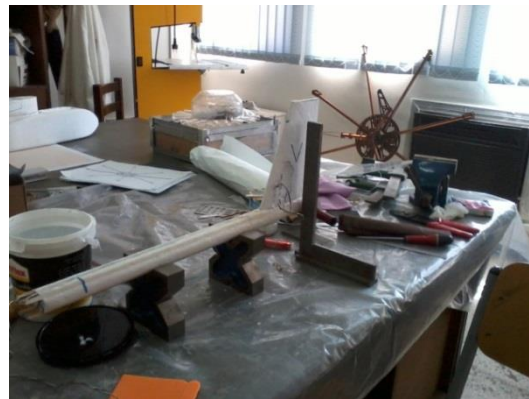
Fig. 6-33 : La poutre avec la gouverne verticale
