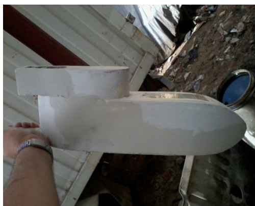
Fig. 6-41 : Le mastic sur le fuselage
