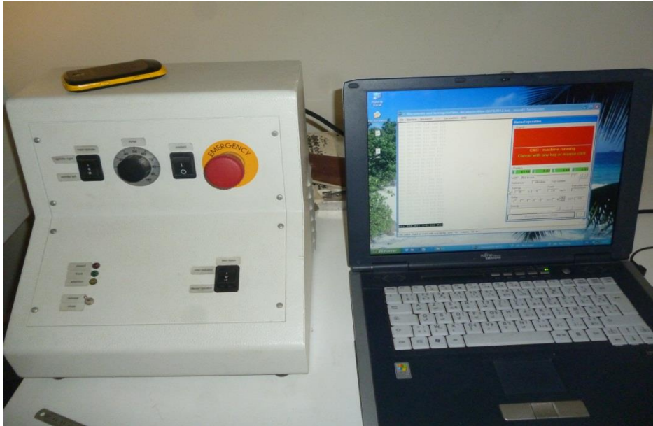
Fig. 6-2 : Dispositif de commande numérique de la machine CNC
