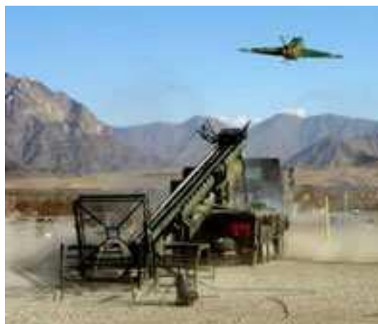
Fig. 1-9 : Catapultage opérationnel d'un Sperwer en Afghanistan
