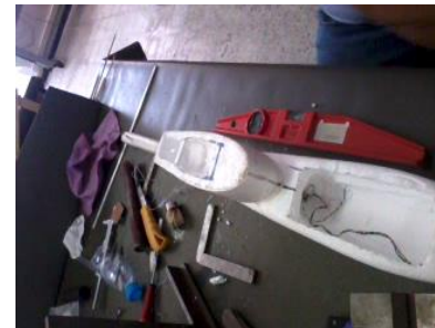
Fig. 6-27 : La fixation de l'aile, le moteur, la poutre de queue et les équipements électroniques
