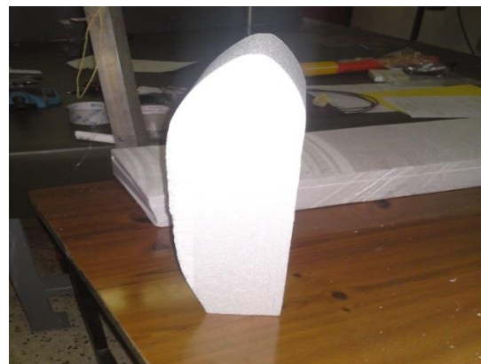
Fig. 6-7 : la forme de dessous de fuselage
