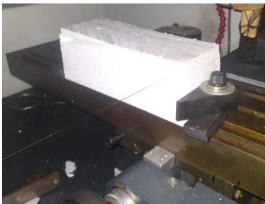
Fig. 6-6 : Découpage latérale de fuselage
