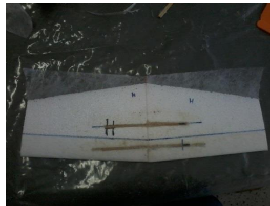
Fig. 6-37 : Fixation des deux parties
