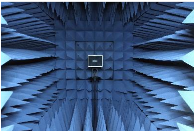
Fig. 1.3 Antenne cornet pyramidale dans la chambre anéchoïque Cal Poly Microwave Lab
