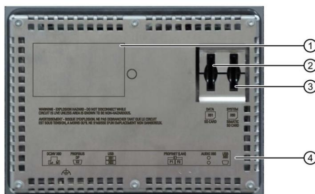
Figure II.17 Vue arrière de L'IHM TP 700 COMFORT
