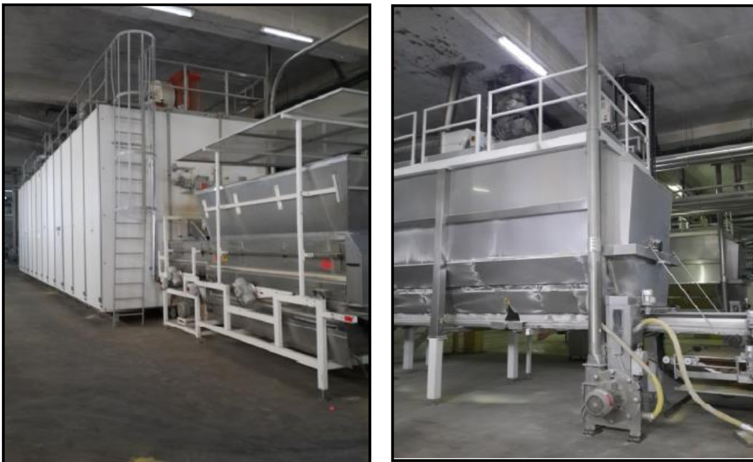
Figure 1.4 : ligne de production des pâtes ( couscous)
