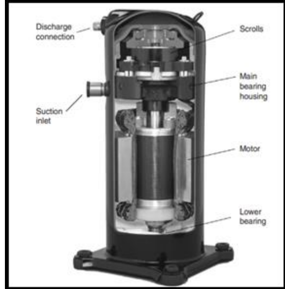
Figure 2.6 :les composants de compresseur
