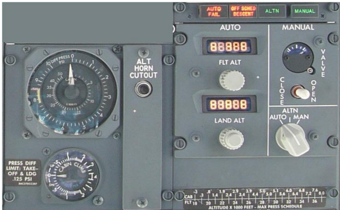
Figure II.2 : Tableau de pressurisation cabine
