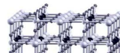
Fig.4.1: configurations géométriques de symétrie  $P_{2mm}$  associées aux rapports atomiques Sb/Sn = 9.09, 14.28, 20 et 26.31%. Les structures géométriques d'équilibre (a), (b), (c) et (d) sont les plus stables. Les balles de couleur grise foncée, grise claire et noire désignent respectivement les atomes O, Sn et Sb.
