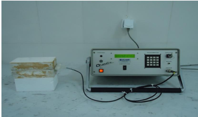
Figure 3.10 : Appareil CT-METRE
