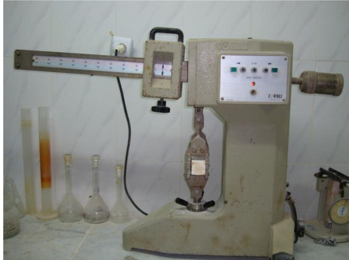
Figure 3.5 : Appareil de flexion (CONTROLS)
