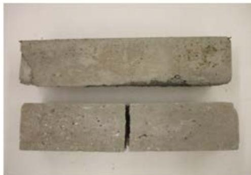
Figure 1.28 : Eprouvettes prismatiques en mortier ciment pour essai de flexion
