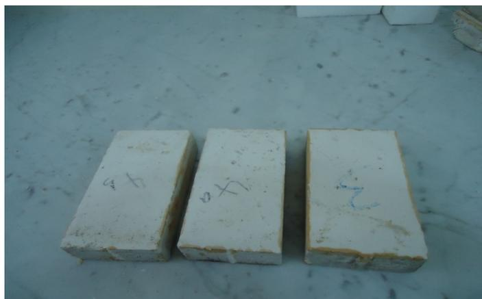
Figure 3.11 : Trois éprouvettes de dimension (200 mm x 150 mm x 50 mm)
