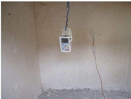
Figure 4.9 : Mesure de la température de l'air
