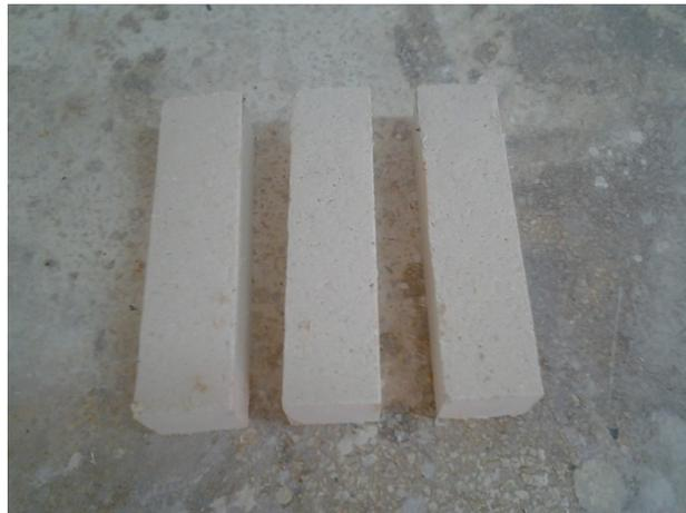
Figure 3.6 : Prismes de plâtre (160 mm x 40 mm x 40 mm)
