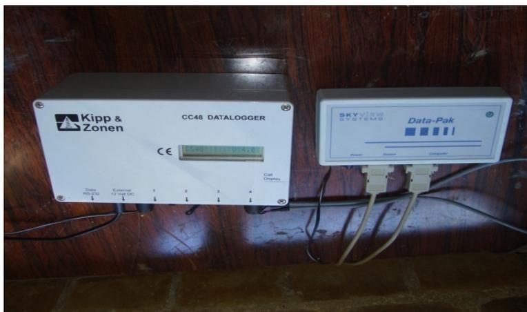
Figure 4.15 : Système d'acquisition du Pyranomètre CC 48 KIPP&ZONEN
