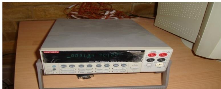
Figure 4.8 : Système d'acquisition KEITHLEY 2700 (40 voies de mesures)
