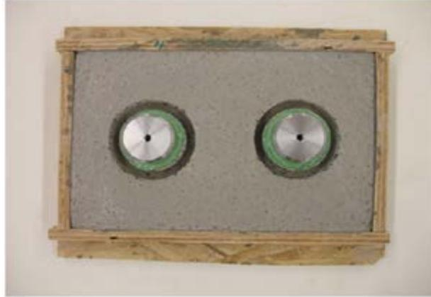
Figure 1.29 : Spécimen utilisé pour l'essai d'arrachement
