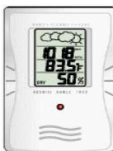
Figure 4.12 : Baro-thermo-hygromètre
