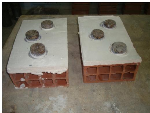
Figure 3.8 Échantillons pour faire l'essai d'adhésion
