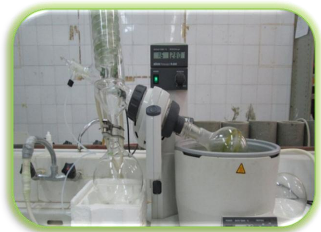
Figure 11 : Evaporation sous vide par rotavapor de type Heidolph
