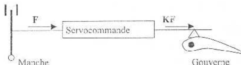
*Fig-IV-4 : Le rôle d'une servocommande.*
