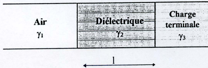
Figure 1 : représentation de la ligne à air contenant l'échantillon
