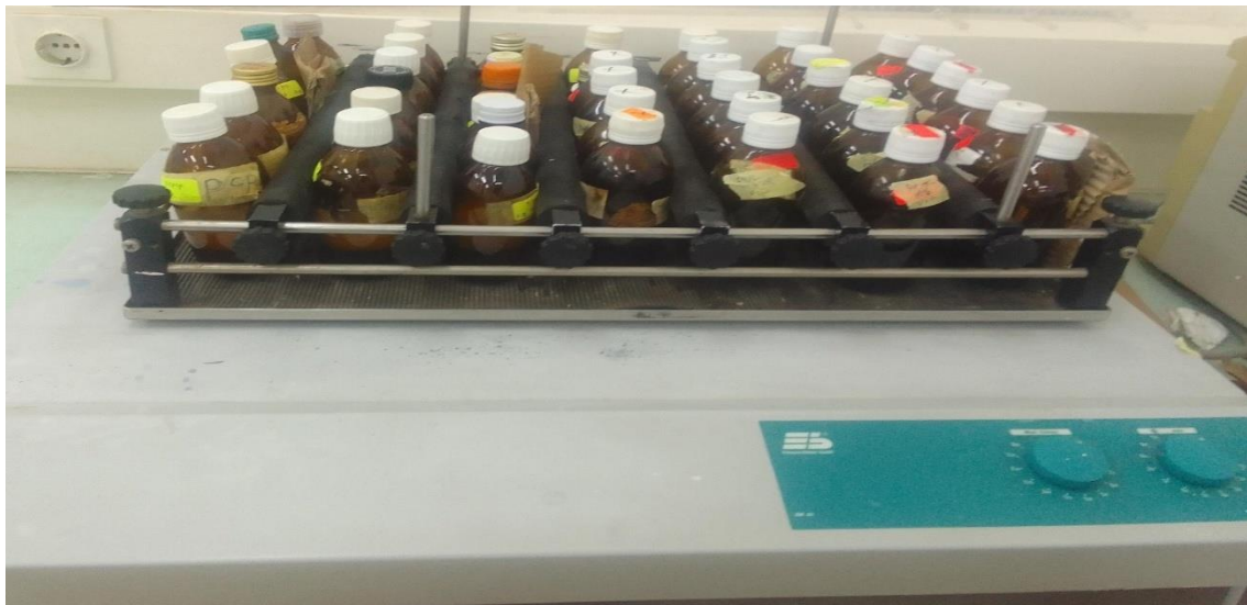
Figure II.6 : Photographie numérique montrant le secoueur Edmund Bühler GmbH SM-30 utilisé dans l'étude de la cinétique de sorption.
