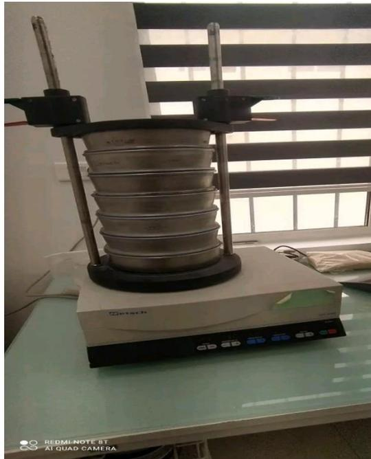
**Figure ANNEXE 1 :** Image d'un tamiseur type (Retsch AS200)
