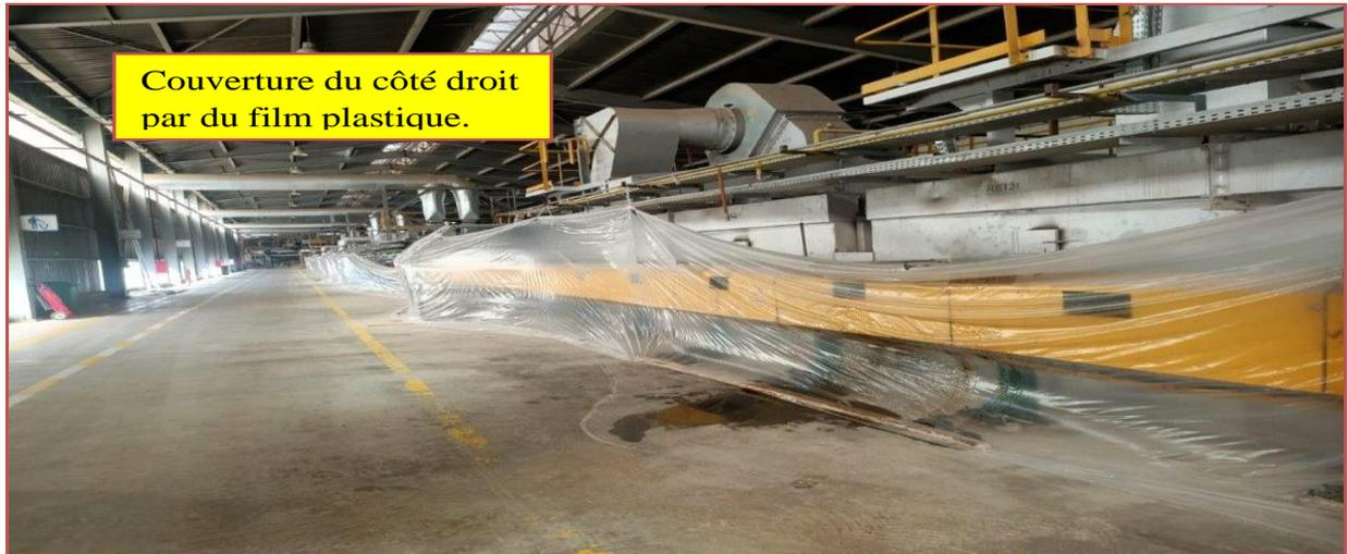
*Figure III.6: Les infiltration d'air qui prédominent sur le cote droit de l'étenderie*
