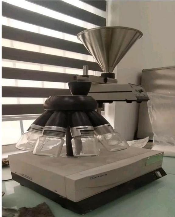
**Figure ANNEXE 2 :** Image d'un diviseur rotatif de type (Retsch PT100)
