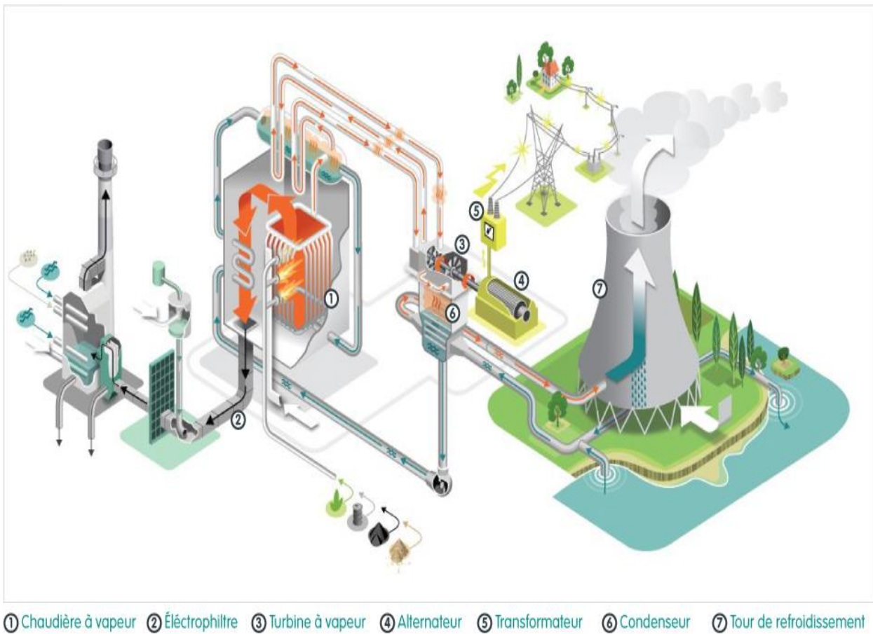
Figure 1.2. Turbine à vapeur
