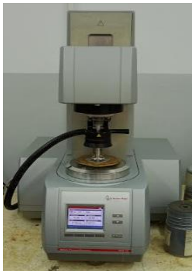
Figure 2.13 : Le rhéomètre de type MCR 302 Anton-Paar (photo personnelle , 2023)
