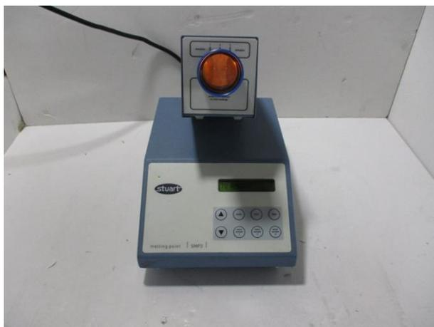
**Figure 2. 10: Fusiomètre.**
