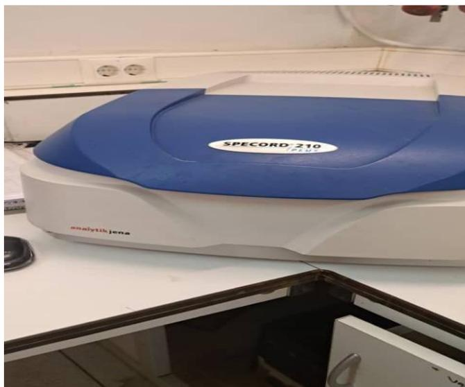
*Figure 12: appareil d'UV-VISIBLE*
