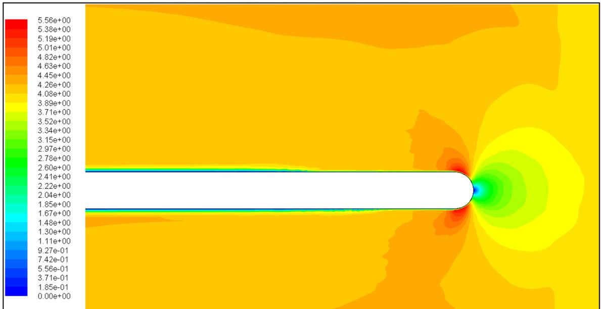
**Figure 4.3:** contours de vitesse calculé avec décharge a  $U_0 = 4\text{m/s}$
