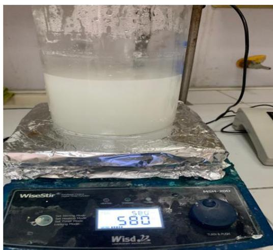
**Figure III.5.** Aspect opaque de la solution méthylolée de l'essai 06.**III.7 Essai 07 ( $\frac{F}{U}$  1.4):**
