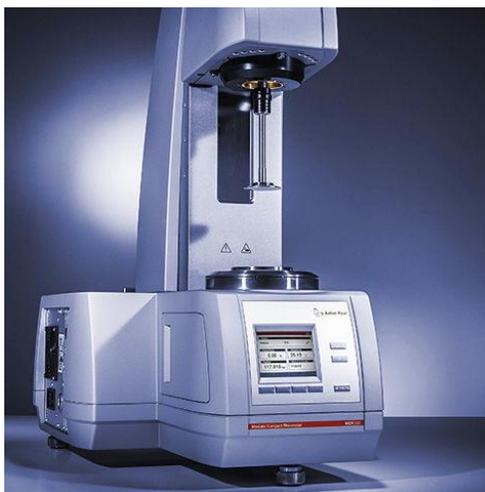
**Figure II.2.** Rhéomètre
