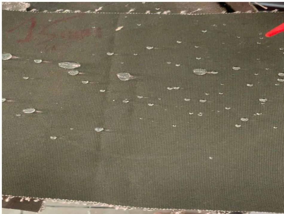
**Figure III.3.** Photo illustrant d'une toile de bâche traitée et imperméabilisée.
