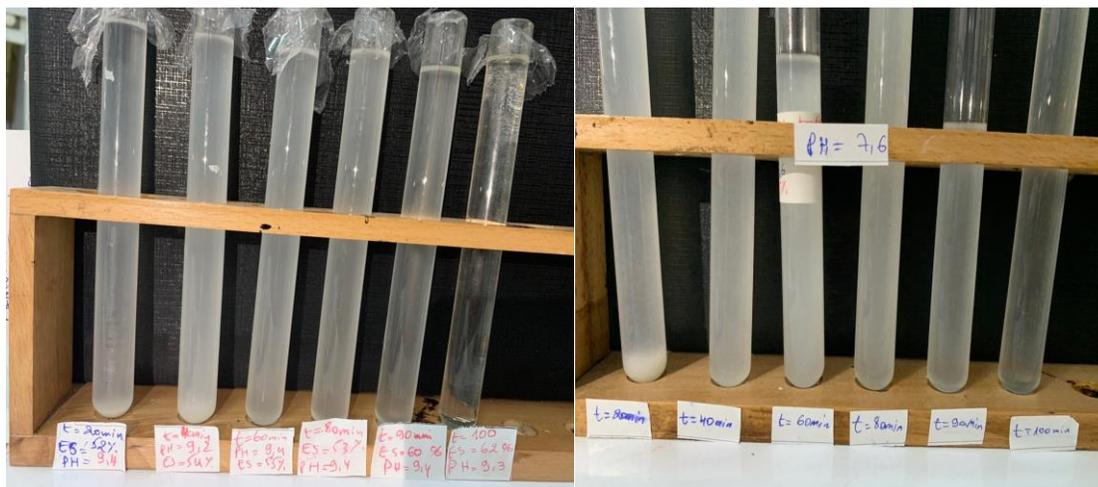
**Figure III.4.** Photos illustrant l'aspect des deux séries des résines méthylolées aux pH 9,2 et 7,6.
