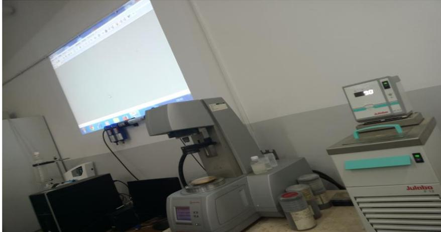
**Figure26 : Rhéomètre Anton ParModularCampactrheometer MCR 302 et un thermostat.**
