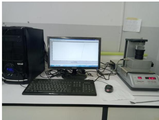
**Figure 27 : Tensiomètre.**
