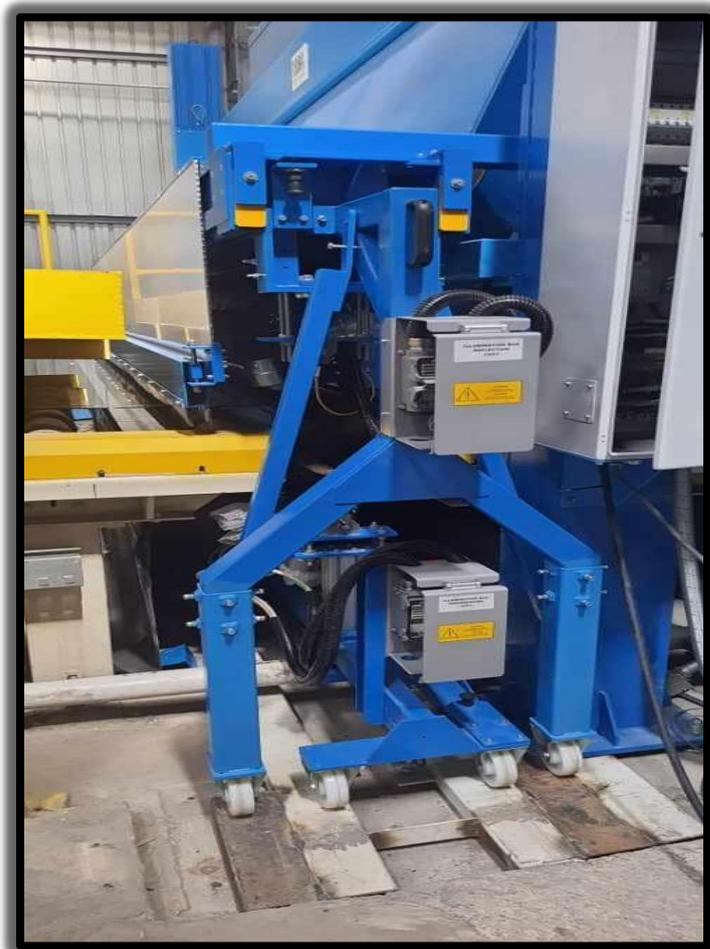
**Figure IV.08** : Photo de système d'inspection « SpecGAGE5D d'ISRA VISION »
