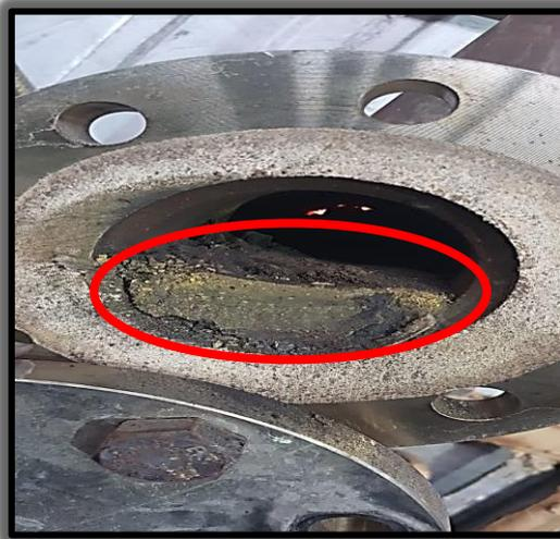
**Figure V.13 :** Photo de l'accumulation de  $\text{SnO}_2$  (PPN).
