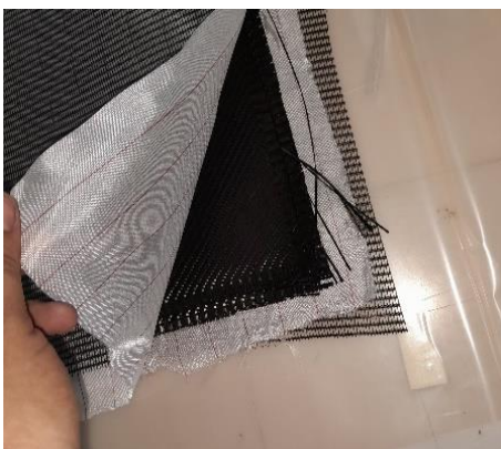
Figure III.5 : Mise en place de l'ensemble des tissus à l'intérieur de l'enveloppe.
