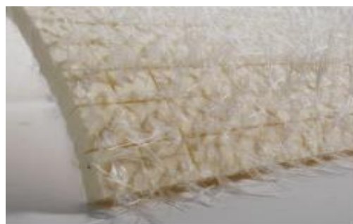
Figure II.8. Mousse polyuréthane renforcée de fibres de verre[44]
