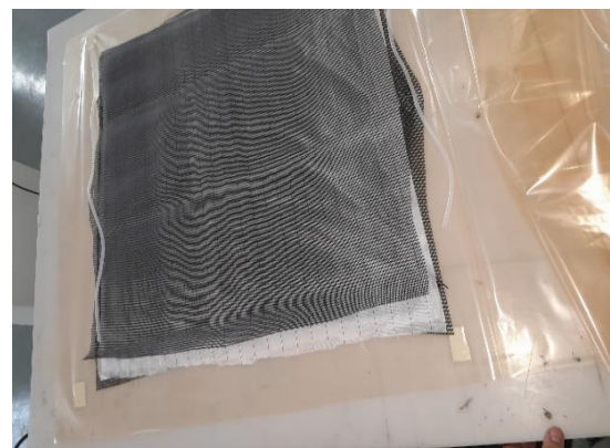
Figure III.5 : Mise en place de l'ensemble des tissus à l'intérieur de l'enveloppe.
