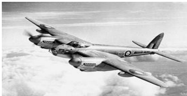
Figure II.14 Avion militaire Britannique, Le Mosquito, en structure sandwiche.[15]
