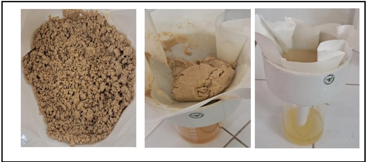
Figure IV.8 : Filtration de la poudre après le montage à reflux (photo originale).
